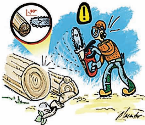
Risco de acidente com o rebote da motosserra
