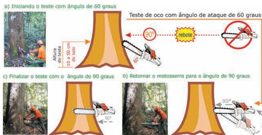
Figura 22. Representação dos procedimentos operacionais recomendados para o teste do oco no ângulo de ataque de 60 graus.
