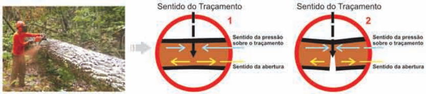
Figura 50. Sentido de compressão e de rompimento de toras apoiadas nas duas extremidades durante a operação de traçamento.
