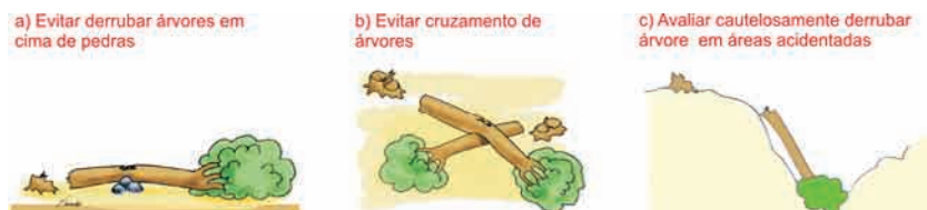
Figura 17. Situações especiais que devem ser observadas durante o corte para evitar os desperdícios de madeira na exploração.
