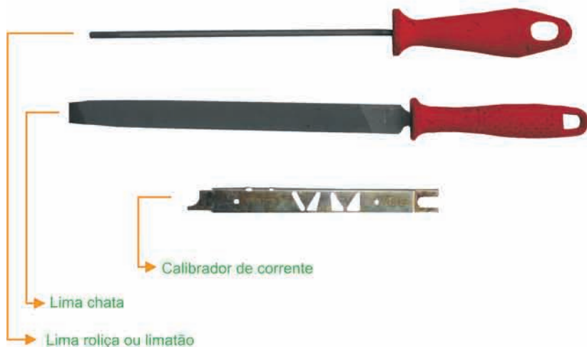
Figura 60. Ferramentas utilizadas para a afiação manual dos dentes da corrente para motosserras.
