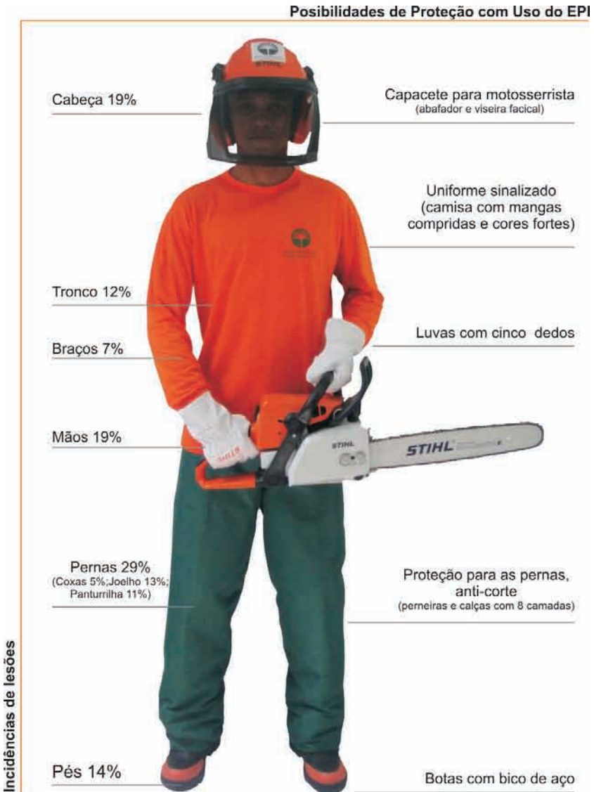
Figura 57. Principais EPIs e regiões com maior incidência de acidentes em operadores de motosserras. Fonte: Stihl ferramentas motorizadas: índices de lesões e possibilidades de proteção.
