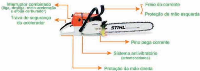
Figura 59. Localização dos principais elementos de segurança da motosserra.
