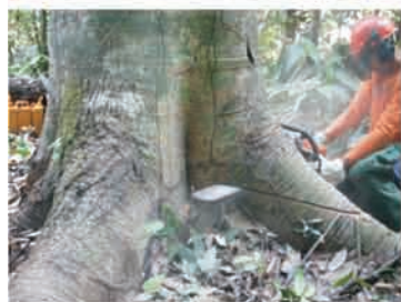
Figura 26. Execução e representação esquemática do corte 0^\circ .
